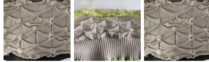
c. İlmek ayarı 50 olarak ayarlanmış deneme yüzey
